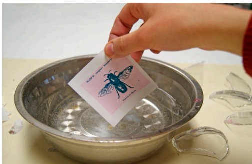
Fig. 5 | Submersão do decalque em recipiente com água.
