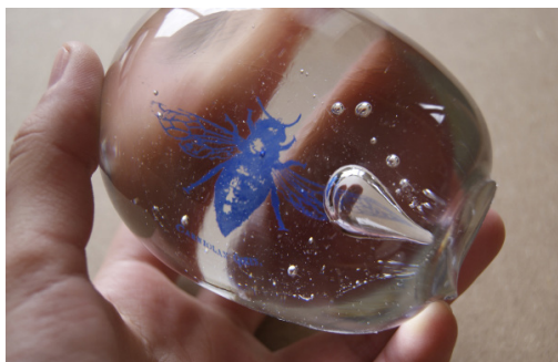
Fig. 8 | Amostra de vidro soprado com inclusão de decalque no interior da massa de vidro.
