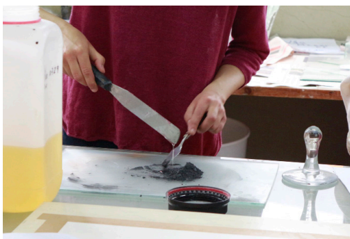
Fig. 2 | Preparação de tinta para impressão com esmalte vítreo e óleo de pinho, para impressão de decalque serigráfico.
