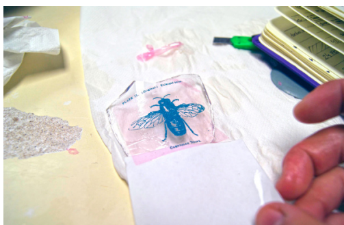
Fig. 6 | Aplicação do decalque sobre substrato vítreo.
