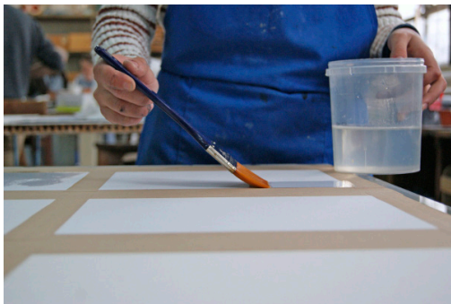
Fig. 1 | Preparação do papel de transporte com revestimento solúvel.
