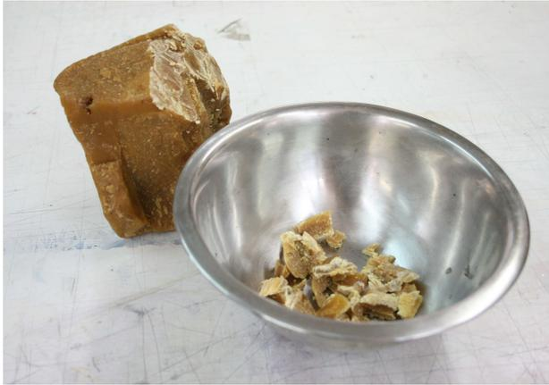
Deixar a cera de abelha derreter completamente antes de adicionar a resina calofónia à mistura. Adicionar pequenas porções de cada vez, permitindo a dissolver a resina. Mexer com uma vareta de madeira.
